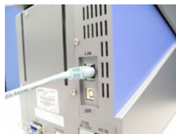
LAN ケーブル接続
