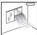
風が吹き込む窓の近く
