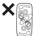
端子電源端子露出
